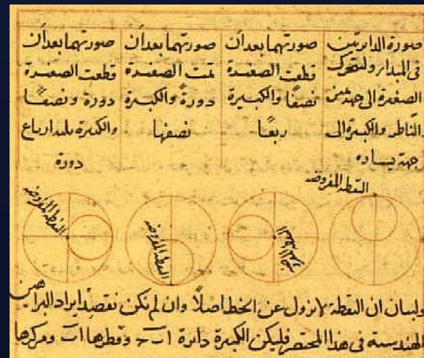
Tusijev par - skica Nasira al-Dina Tusija iz 13. veka. Generiše pravolinijsko kretanje kao zbir dva kružna kretanja. Osmišljen je za Tusijev planetarni model.
